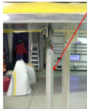
**Nach korrekter Montage darf keine Verdrehung möglich sein.**
