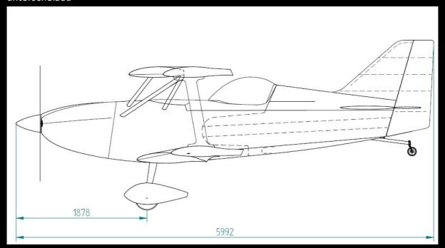
Augenscheinlich ist dies neben einem neuen Tragflügel mit veränderten Flaperons auch ein vergrößertes Höhen-und Seitenleitwerk. Beides wurde um 20% vergrößert, eine verbreitertes und höheres Fahrwerk, ein geänderter Motorträger sowie die optional erhältliche Rennhaube (für den einsitzigen Betrieb) runden das Änderungspaket ab.
