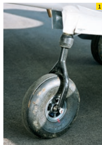
1 Früher So sah die Bugradgabel der VL-3 aus, als die noch 472,5 Kilo Höchstabflugmasse hatte. Ausgelegt war die Gabel für 560 Kilo MTOM
